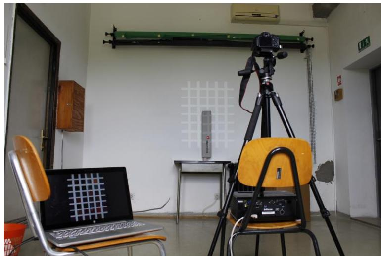
Slika 9. Projektor na udaljenosti 4 metra od zida sa fotoaparatom na stativu direktno iznad projektoru
