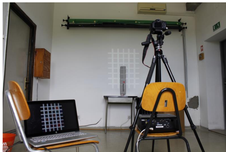
Slika 9. Projektor na udaljenosti 4 metra od zida sa fotoaparatom na stativu direktno iznad projektora
