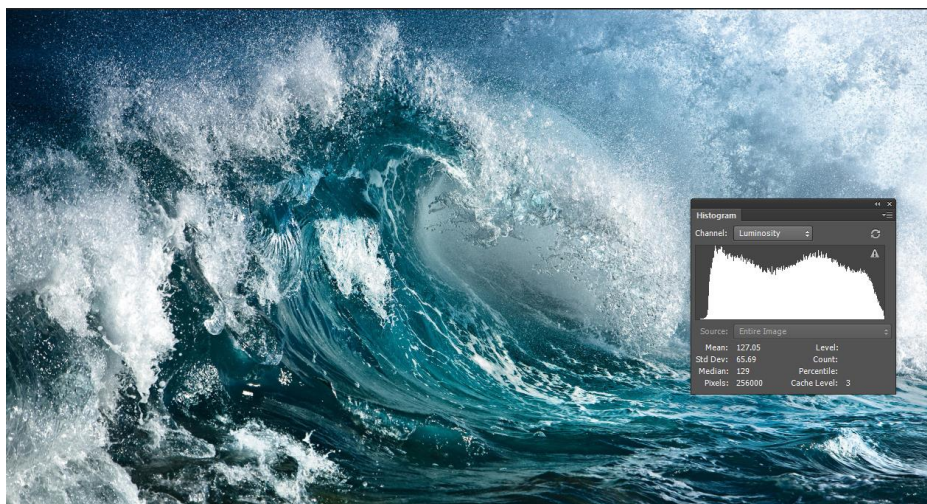
Slika 11. Fotografija klasificirana kao „srednje svijetla” projekcija. Najviši vrhovi grafa nalaze se bliže lijevoj strani što inicira da na pojedinim kanalima fotografija ima puno tamnih tonova. Kako se histogram distribuira kontinuirano na svim razinama uzeta je brojčana vrijednost za određivanje stupnja svjetline i ta vrijednost iznosi 127,5
