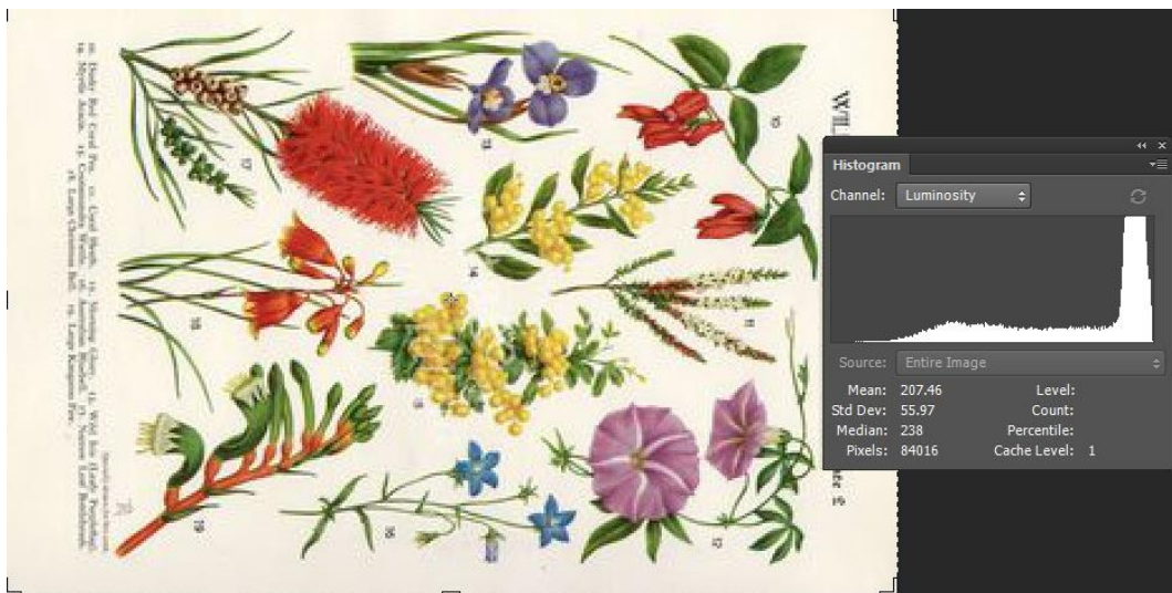
Slika 10. Pomaknutost histograma udesno i njena vrijednost koja iznosi 207,46 klasificiraju ovu fotografiju kao „svijetlu projekciju”
