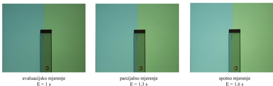
Slika 26. Velike uniformno obojene površine mogu „zbuniti” svjetlomjer pa su za različite metode mjerenja svjetla izračunate različite optimalne ekspozicije
