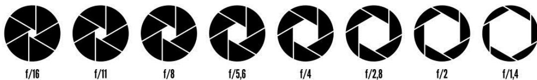
*Slika 16. Otvori zaslona fotografiskog aparata i pripadajuće brojčane vrijednosti. Svaki f-broj označava duplo veći otvor zaslona od prethodnog i posljedično duplo više svjetlosti dospijeva na senzor. Veličinom otvora zaslona kontrolira se i dubinska oštrina koja je veća što je manji otvor zaslona, odnosno veći f-broj.*
