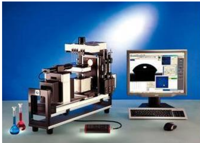
Slika 15. Optički goniometar Dataphysics OCA
