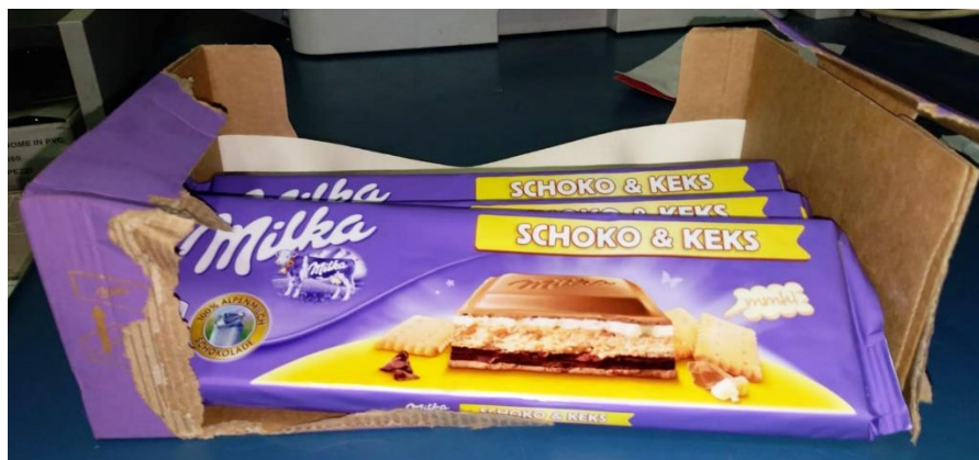
Slika 19 Prikaz loše optrganog SRP-a (izvor: osobna fotografija)
