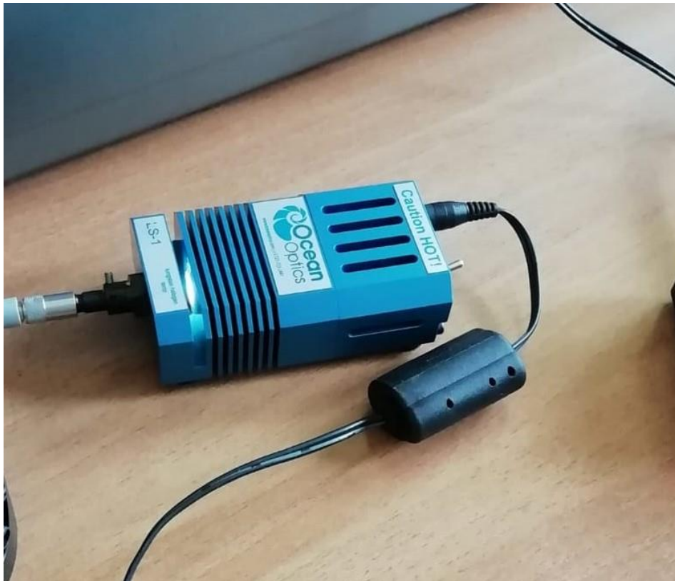
Slika 14 – Izvor svjetla, LS-1 (Tungsten-halogen lampa)
