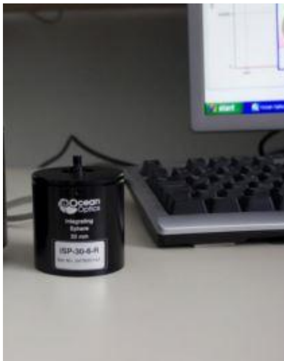
Slika 13 – Integracijska sfera OcenOptics ISP-30-6-R-GT
