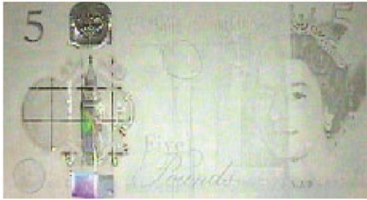
Slika 54 Lice novčanice od £5 pod IR svjetlom
