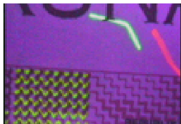
Slika 14 Nevidljiva zaštitna vlakna pod UV svjetlom
