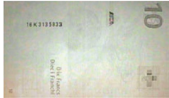
Slika 57 Naličje novčanice od 10 CHF slikano pod IR svjetlom
