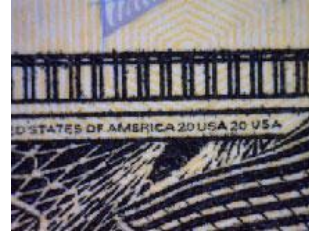
Slika 26 Dio vinjete i mikrotiska otisnuti intaglio tiskom na novčanici od 20 USD
