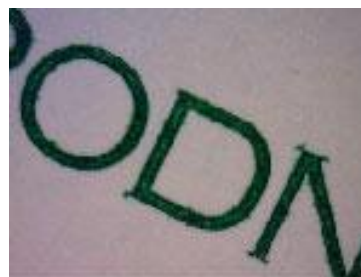
Slika 27 Dio natpisa "HRVATSKA NARODNA BANKA" na licu novčanice od 200 HRK izveden ispušćenim tiskom
