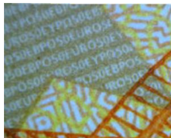
Slika 30 Dio mirkoteksta na novčanici od 50 EUR
