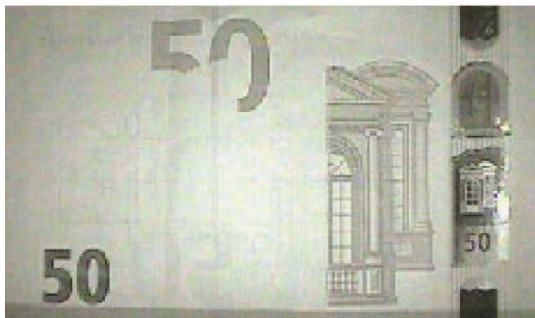
Slika 60 Lice novčanice od 50 EUR pod IR svjetlom
