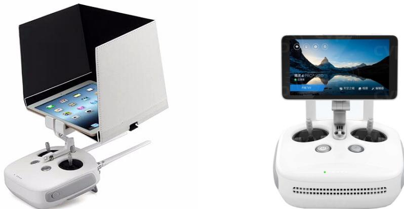
*Slika 7. Usporedba: Upravljač Phantom-a 3 sa eksternim uređajem (iPadom) i sjenilom za bolju vidljivost te upravljač Phantom-a 4 sa integriranim ekranom*
