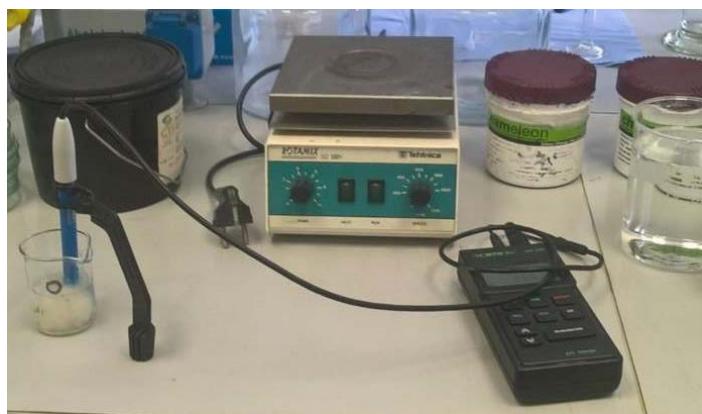
Slika 17 . Mjerenje pH vrijednosti papira WTW pH 340/SET-1 pH metrom
