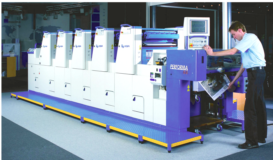
Slika 9. Ofsetni stroj KBA Performa 66-4 formata A2 (485 x 660 mm) [9]
