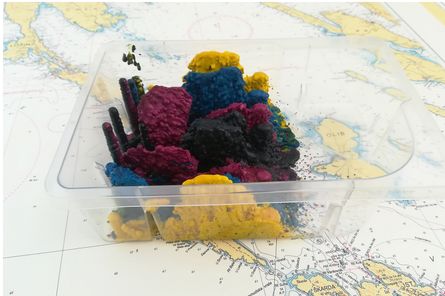
Slika 20. Kutija za otpad - otpadni toner vraća se natrag u čvrsti oblik koji je netoksičan i može se zbrinuti kao uredski otpad
