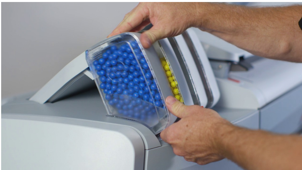
Slika 17. Jednostavna izmjena prozirnih uložaka s TonerPearl kuglicama
