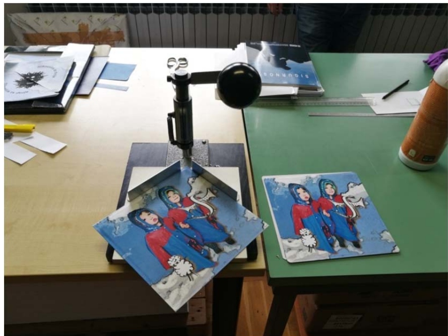
Slika: Obrada rubova slikovnice
