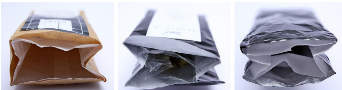
Slika 3. Unutarnji slojevi ambalaže za čaj, redom: masni papir, prozirna folija, aluminijska folija
