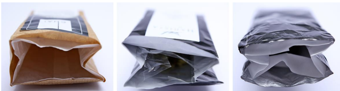
Slika 3. Unutarnji slojevi ambalaže za čaj, redom: masni papir, prozirna folija, aluminijska folija
