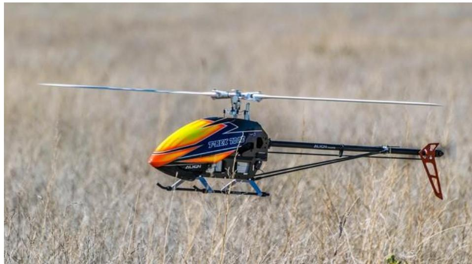
*Slika 3. Dron s jednim rotorom*
