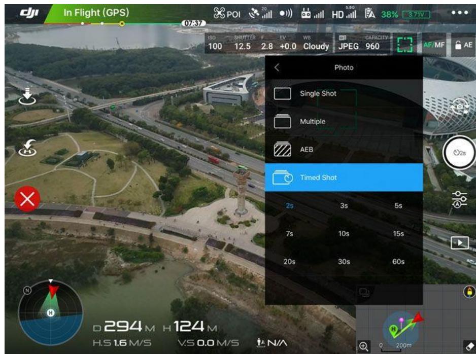
Slika 14. Postavljanje drona na intervalni način rada
