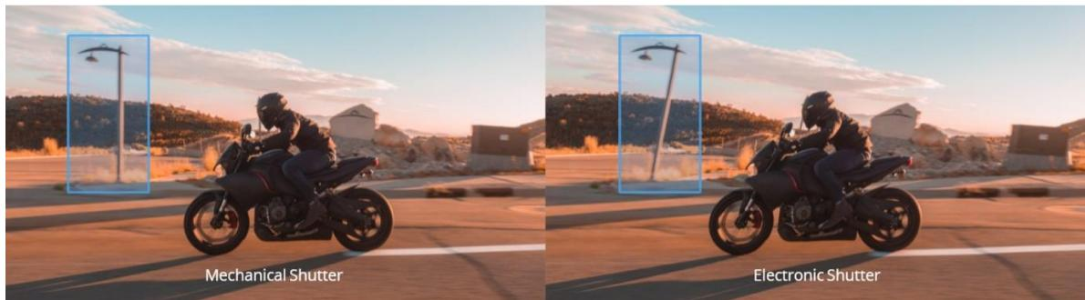
Slika 16. Usporedba mehaničkog i elektronskog zatvarača
