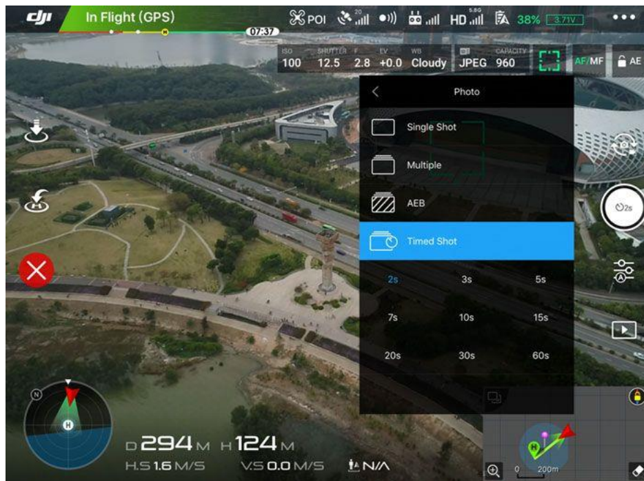
Slika 14. Postavljanje drona na intervalni način rada
