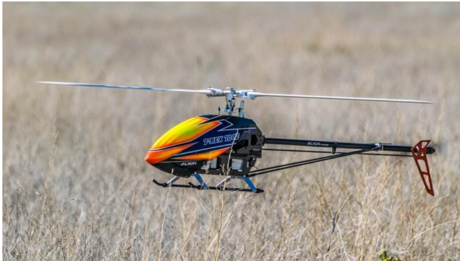
Slika 3. Dron s jednim rotorom
