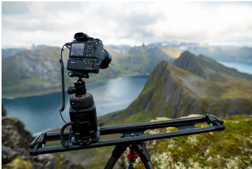
Slika 13. Intervalno snimanje timelapse fotografije pomoću klizača
