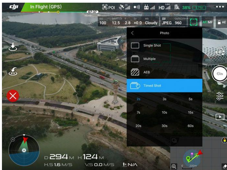
Slika 14. Postavljanje drona na intervalni način rada
