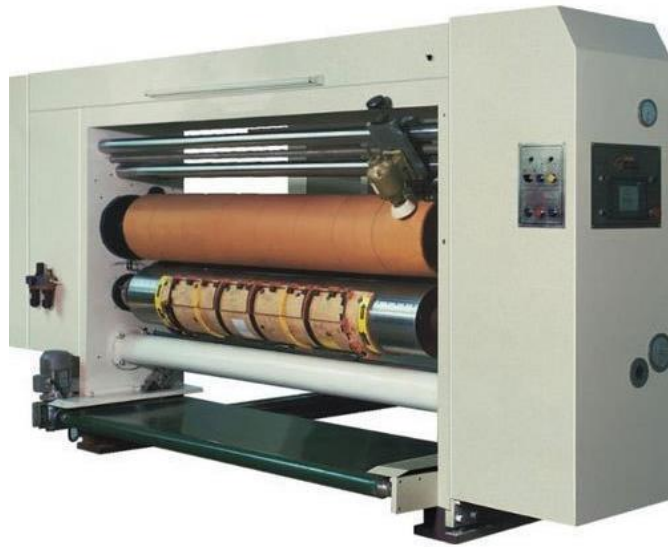
Slika 5. Stroj za rotacijsko rezanje
