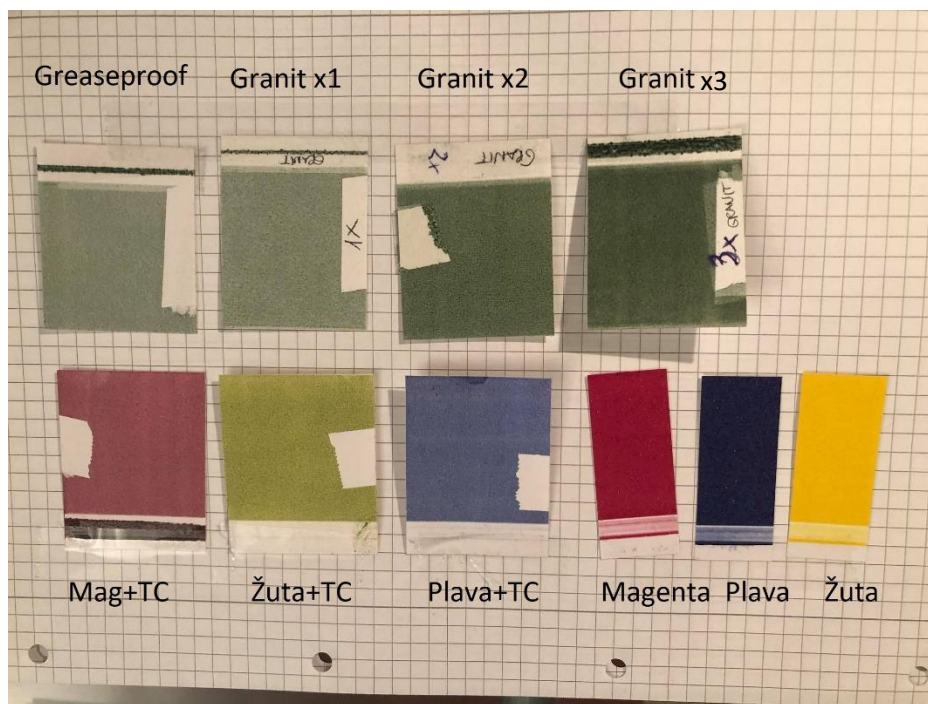
Slika 53. Fotografija uzoraka ispod temperature aktivacije
