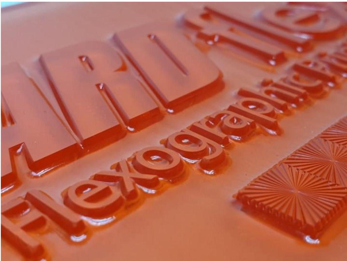
Slika 1. Polimerna tiskovna forma za fleksografski tisak
