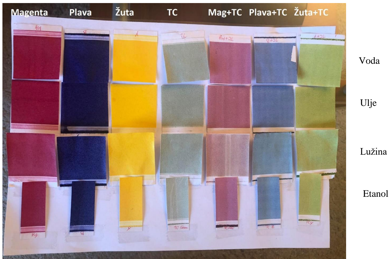
Slika 58. Fotografija uzoraka nakon testa kemijske stabilnosti ispod temperature aktivacije
