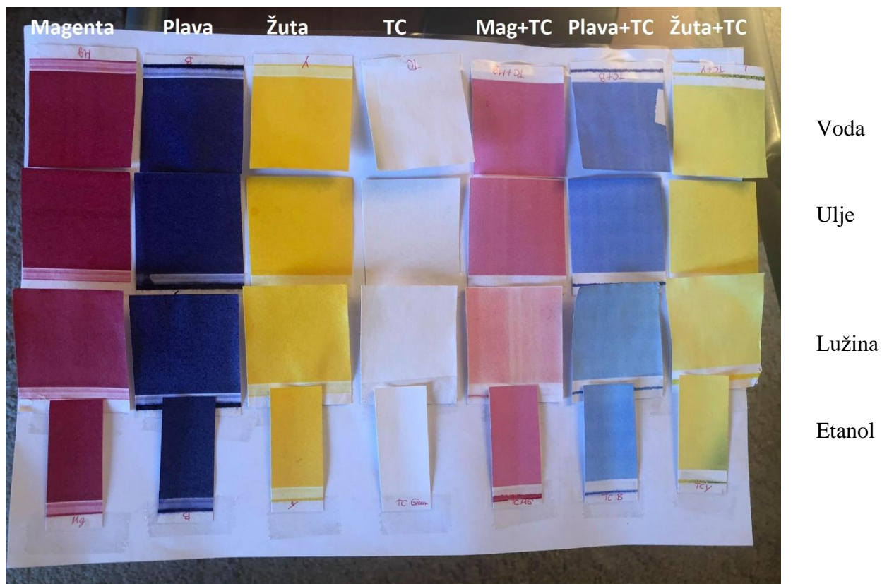
Slika 59. Fotografija uzoraka nakon testa kemijske stabilnosti iznad temperature aktivacije
