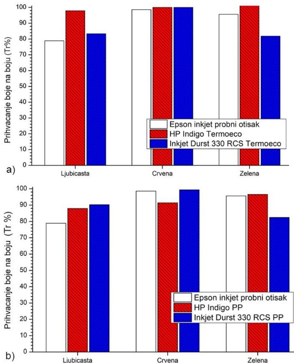
Slika 49 Trapping RGB nijansi za dvije tiskovne podloge: a)Termoeco ScandTherm TCS b)Arconvert OPP TC WHITE GLOSS 60
