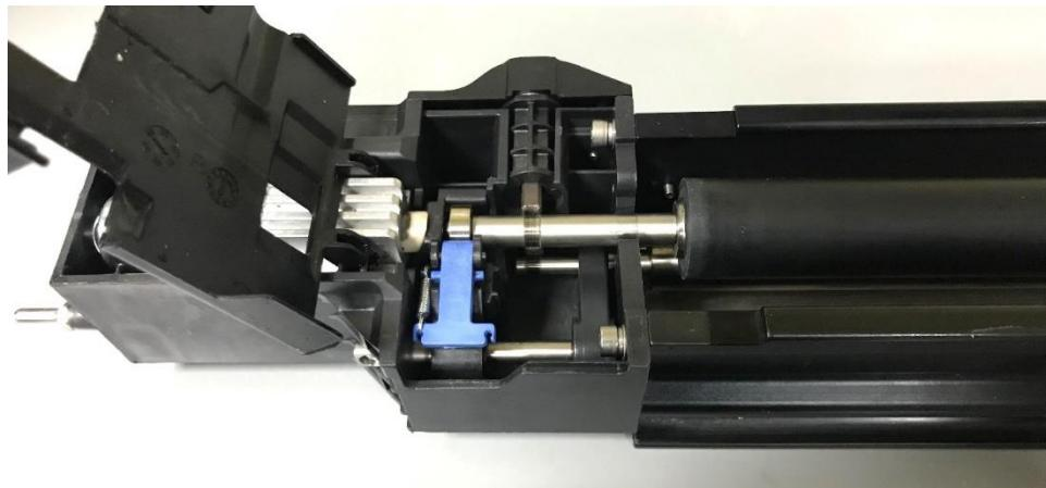
Slika 9 Charge roller kod stroja HP Indigo WS 6900
