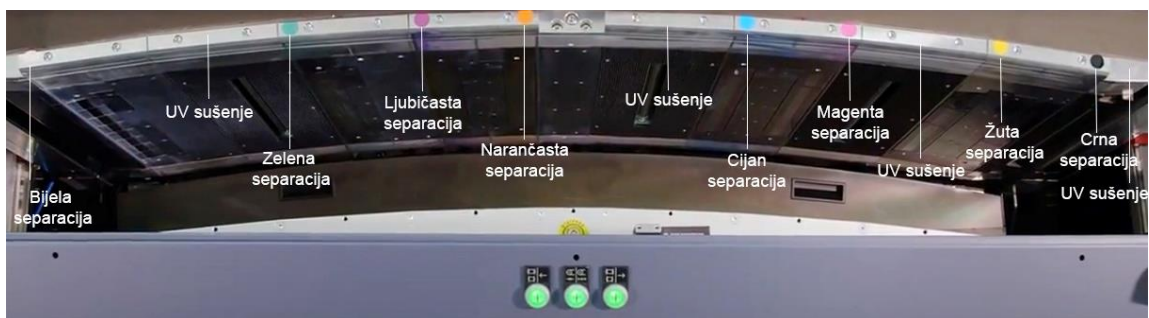
Slika 31 Tiskovna jedinica na stroju Durst Tau 330 RSC
