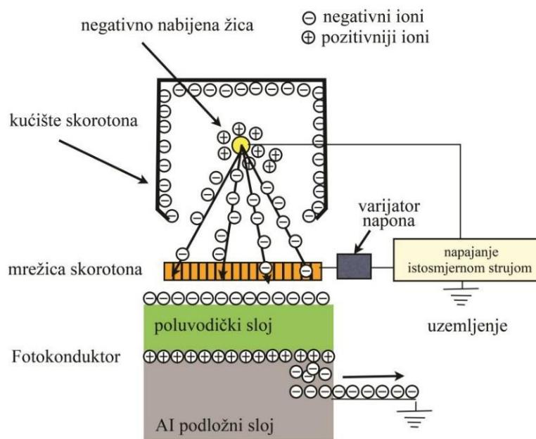
Slika 8 Shematski prikaz nastajanja naboja skorotronom
