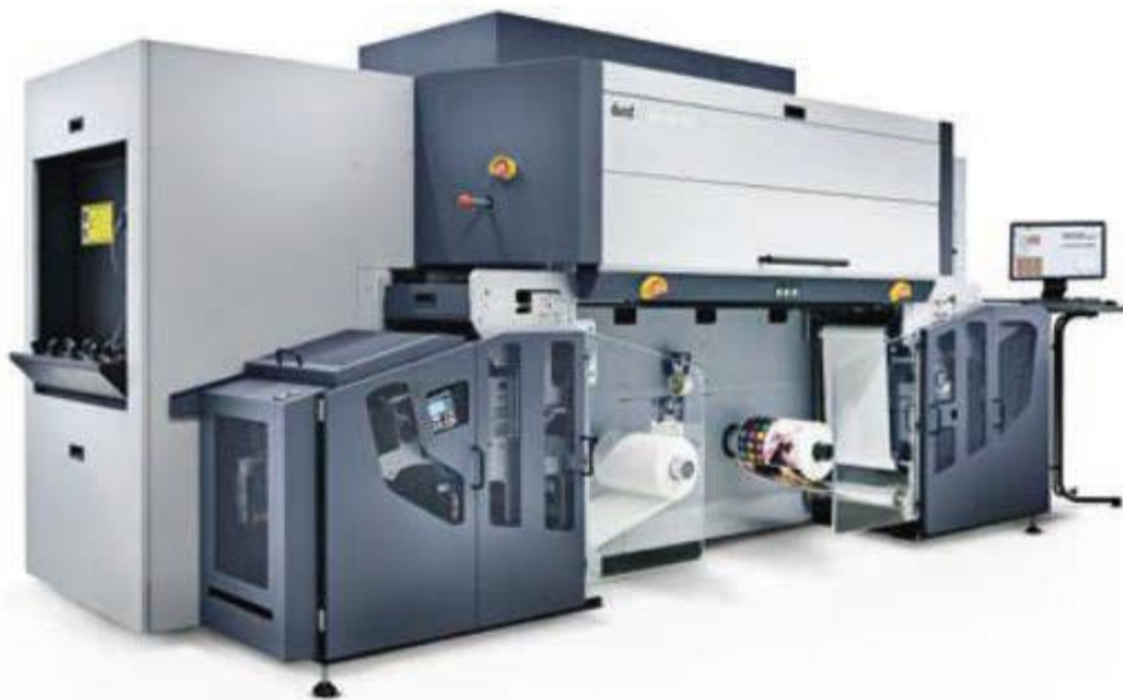
Slika 35 UV-inkjet stroj Durst Tau 330 RSC
