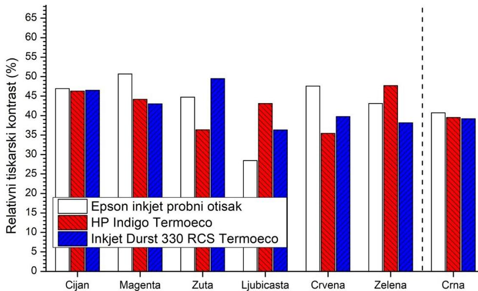
Slika 45 Relativni tiskarski kontrast za tiskovnu podlogu Termoeco ScandTherm TCS
