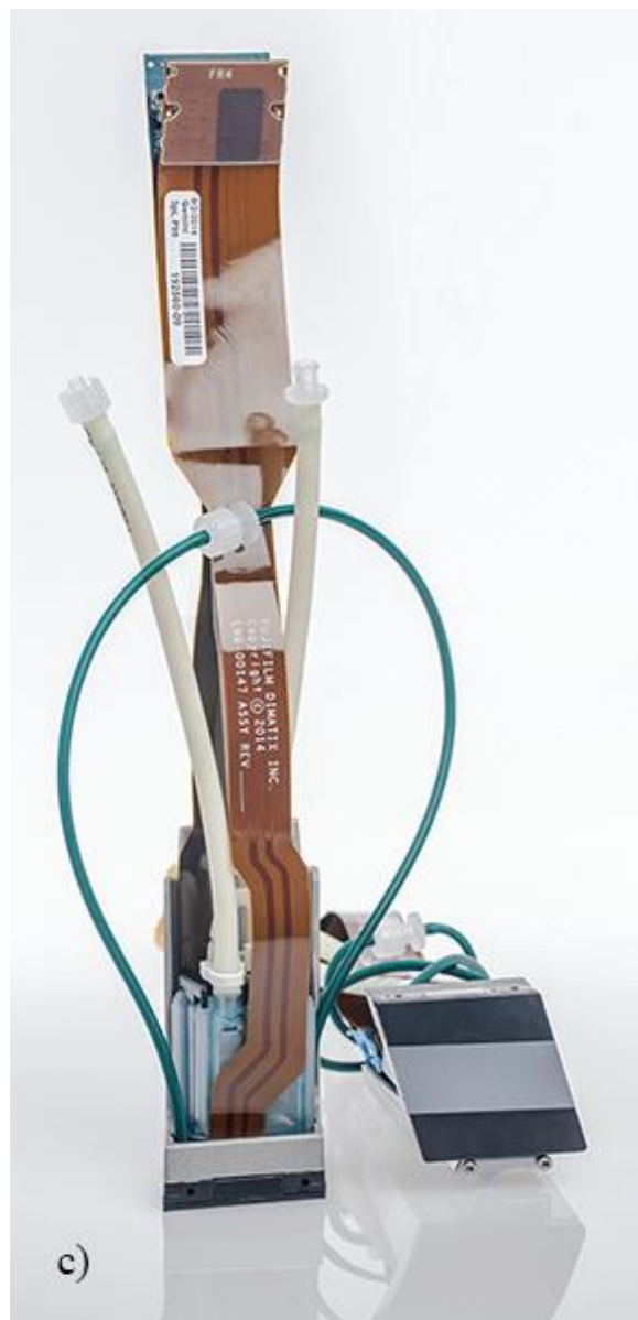
Slika 24 Samba G3L ispisna glava a) shematski prikaz vršnog djela b) shematski prikaz protoka boje c) izvorna fotografija
