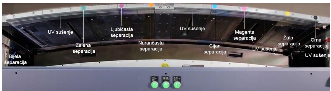
Slika 31 Tiskovna jedinica na stroju Durst Tau 330 RSC
