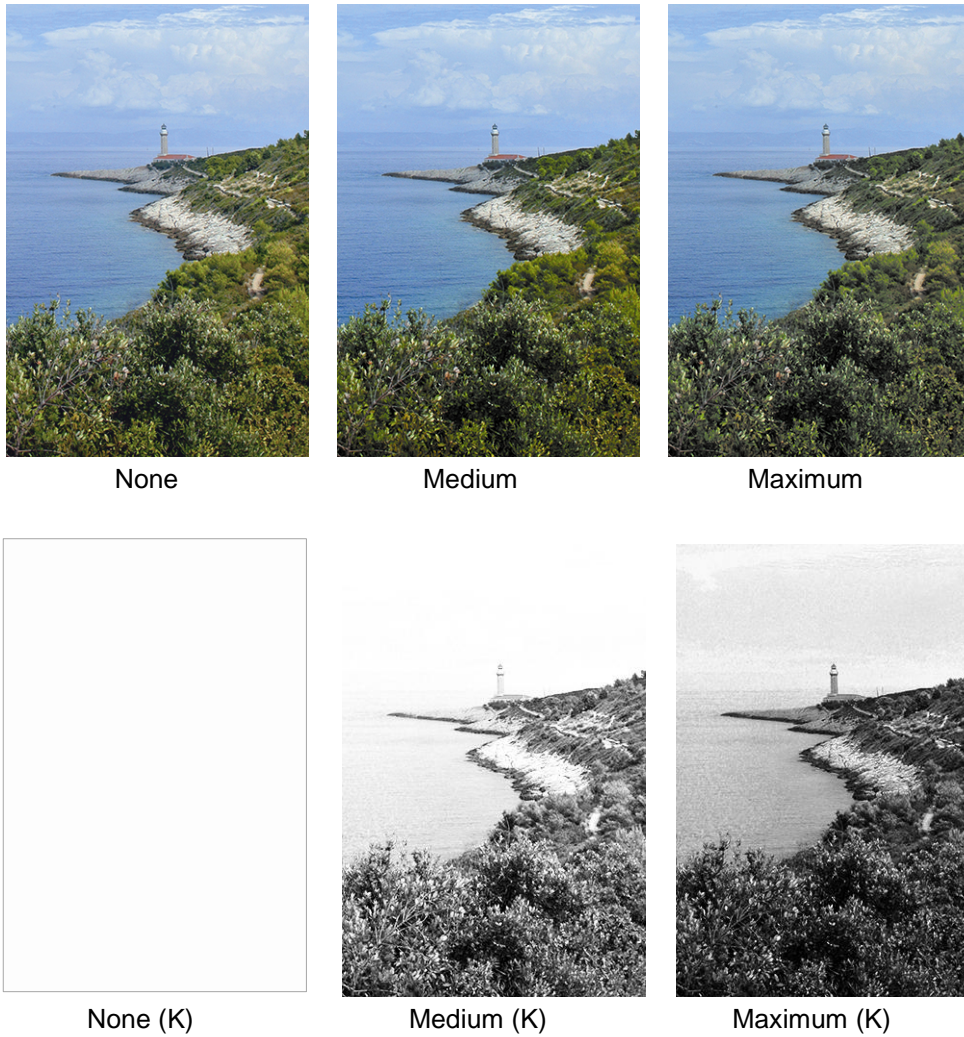
Slika 11. Prikaz slike konvertirane iz RGB u CMYK sustav putem GCR metode s tri načina generiranja crne (None, Medium, Maximum)
