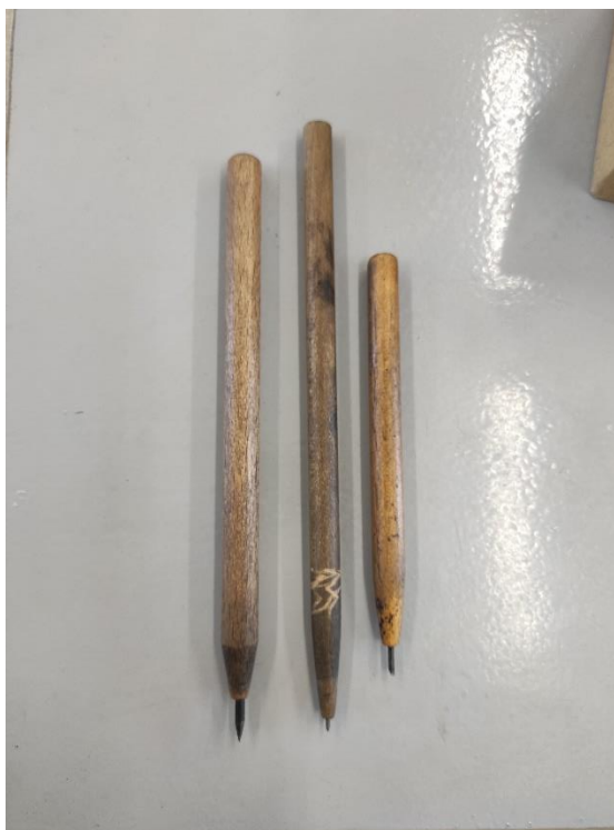
Slika 13. Bakropisne igle (s lijeva na desno: radijalna, precizna, jednofazno brušena)
