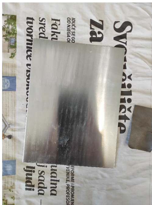
Slika 9. Sirova cink ploča
