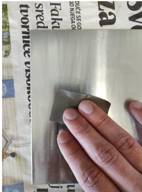
Slika 10. Brušenje cink ploče
