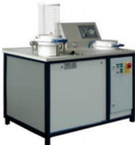
Slika 10. Stroj Rapid Köthen za izradu laboratorijskih listova
