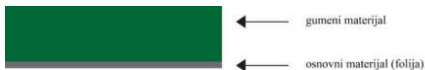
Slika 13 Jednoslojna tiskovna forma
