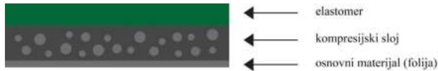
Slika 14 Višeslojna tiskovna forma
