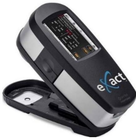
Slika 24. Spektrofotometar X-Rite eXact Adavced
