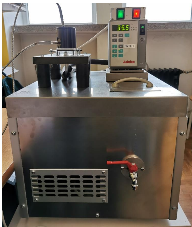
Slika 11. Uredaj za zagrijavanje/hlađenje uzoraka
