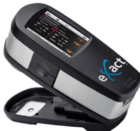
**Slika 10.** Spektrofotometar X-Rite eXact
