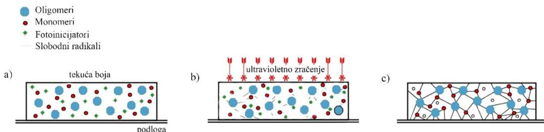
**Slika 7.** Proces stvrdnjavanja laka a) tekući lak, b) proces polimerizacije, c) tvrdi film
