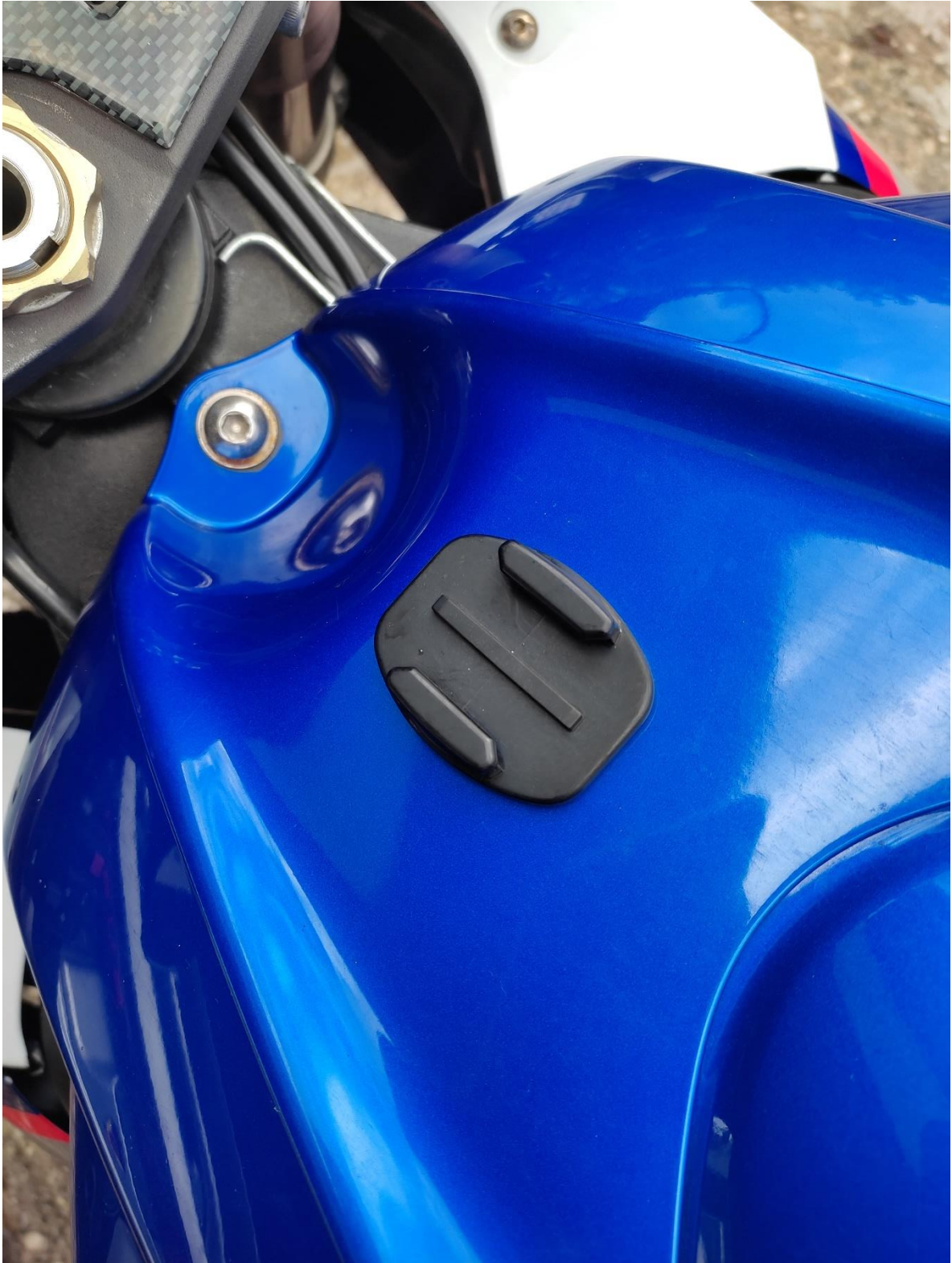
Slika 8- GoPro nastavak za montiranje kamere na rezervoar
