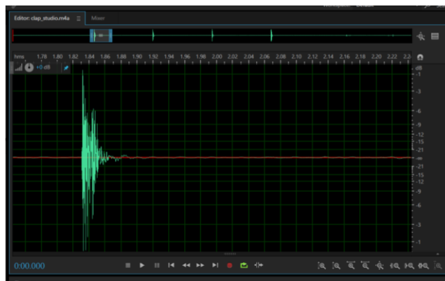
Slika 22: valni prikaz zvuka pljeska u improviziranom studiju
