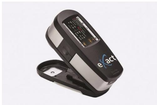
Slika 11. X-rite eXact spektrofotometar
