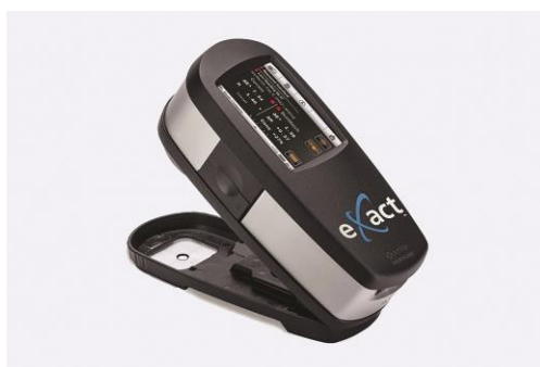
Slika 11. X-rite eXact spektrofotometar
