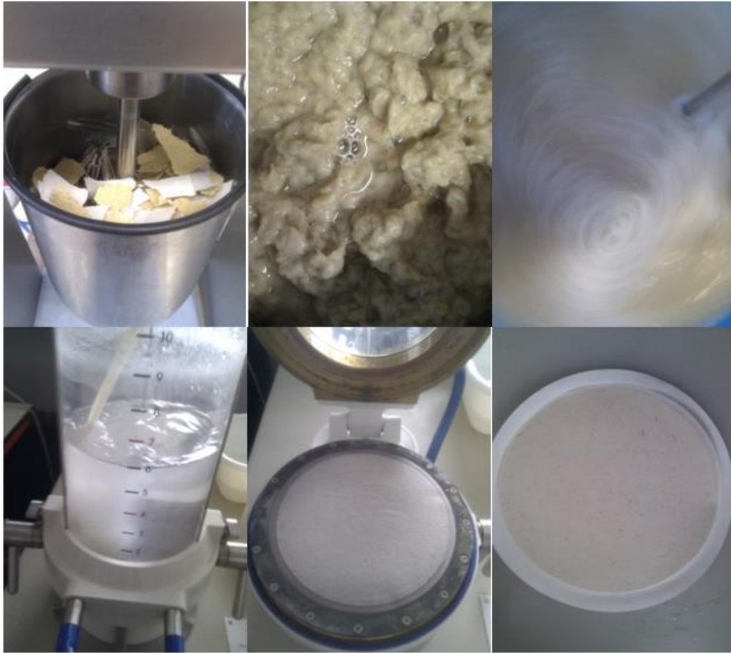
Slika 7. Proces izrade laboratorijskog papira: (a) dezintegracija sirovine; (b) pulpa za izradu papira; (c) homogenizacija suspenzije; (d) izrada papira na Rapid Köthen uređaju; (e) laboratorijski papir; (f) osušeni laboratorijski papir spreman za otiskivanje
