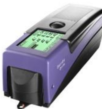
Slika 11. Spektrofotometar X-Rite Spectroeye
