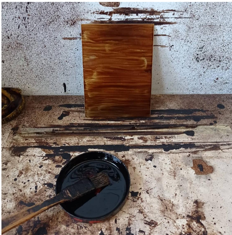
Slika 19 - Nanošenje voska na pločicu
