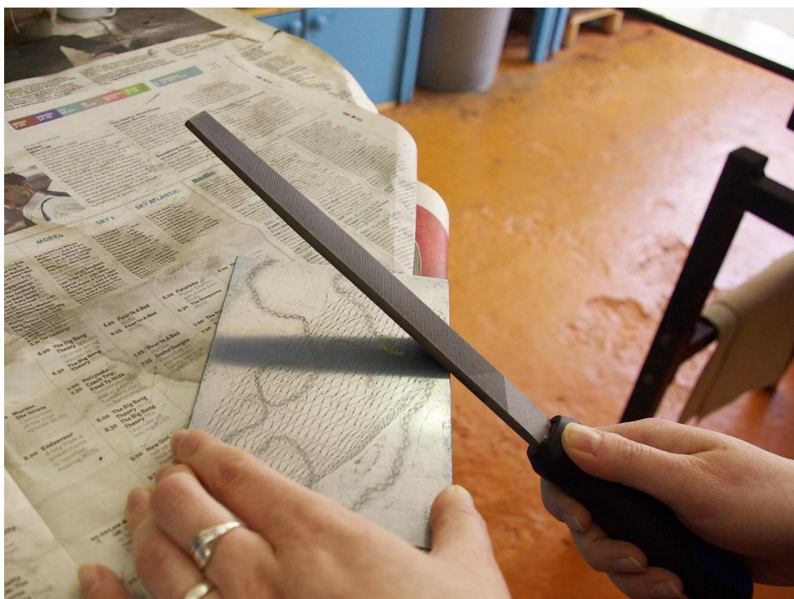
Slika 18 - Zaobljivanje rubova pločice
