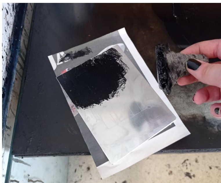
Slika 22 - Nanošenje boje na pločicu
