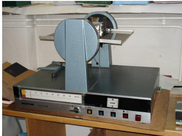
Slika 12.: Martini Tester, Type VA [15]
