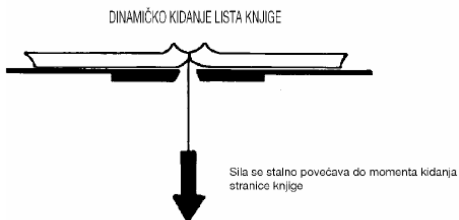
Slika 13.: Shematski prikaz rada aparata za određivanje sile kidanja stranice knjige [15]
