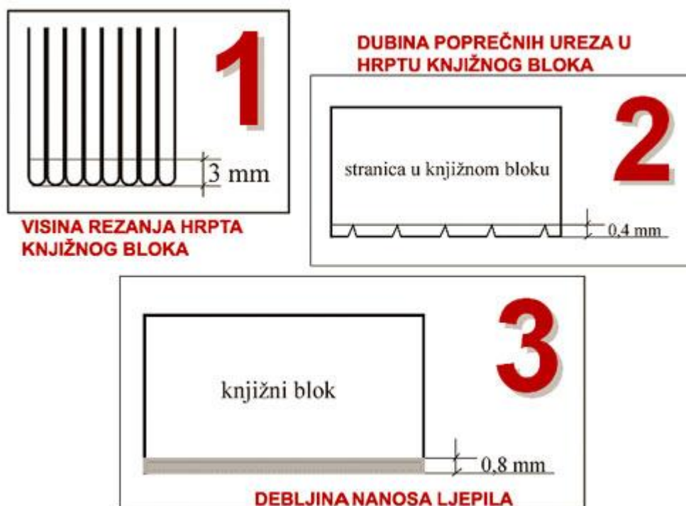
Slika 10.: Prikaz redosljeda tehnoloških operacija obrade hrpta knjižnog bloka [8]
