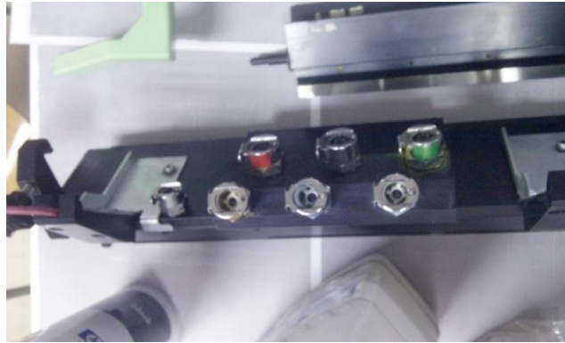
Slika 14. Prikaz ulaznih konektora za mlaznice HP Indigo S1000
