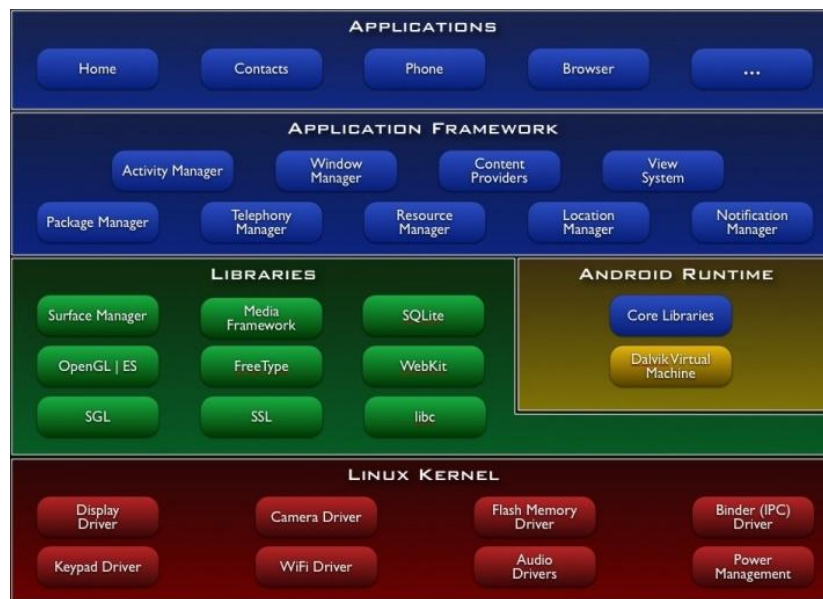
Slika 5. Arhitektura operacijskog sustava Android
