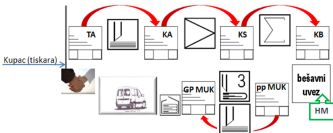
Slika 7. Shematski prikaz strojnog bešavnog uveza [4]
