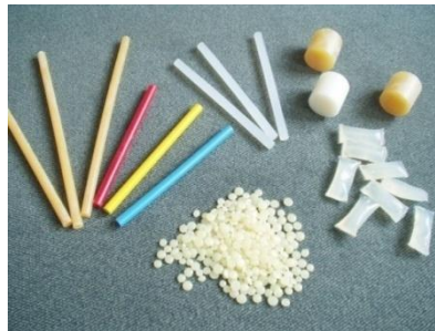
Slika 39. Različite izvedbe hot-melt ljepljiva [38]
