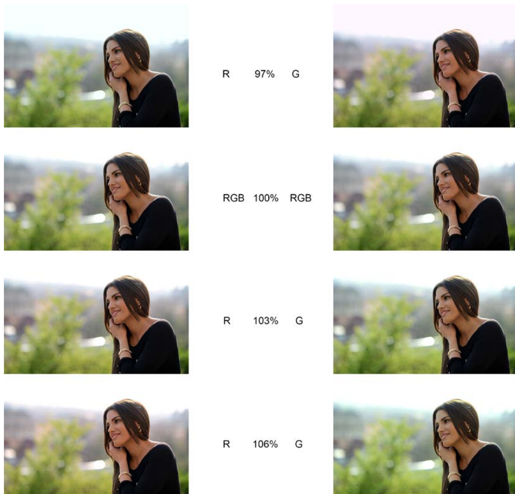
Slika 11. Uzorci s promjenama na crvenom i zelenom kanalu prve fotografije
