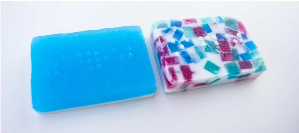
Slika 19. Prototipovi sapuna izrađeni uz pomoć kalupa izrađenog na 3D printeru
