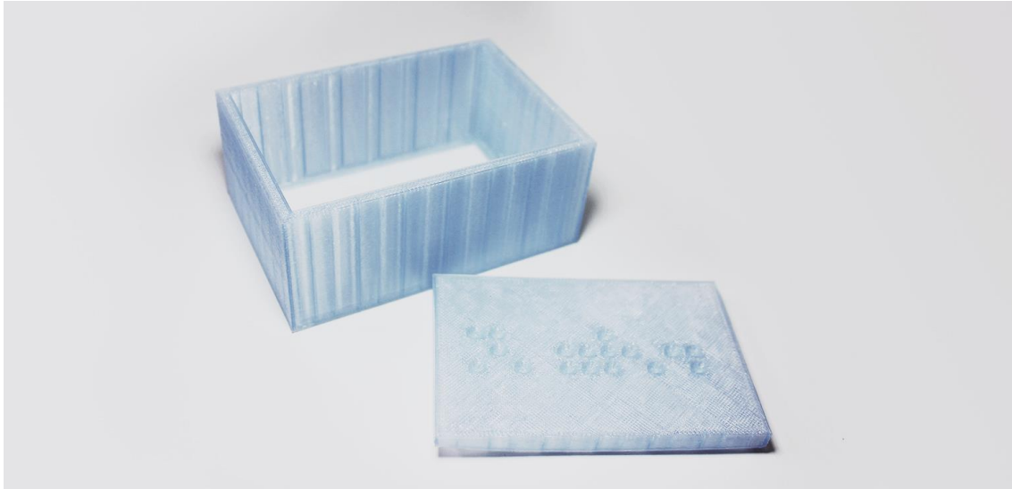
Slika 18. Model kalupa izrađen na 3D printeru
