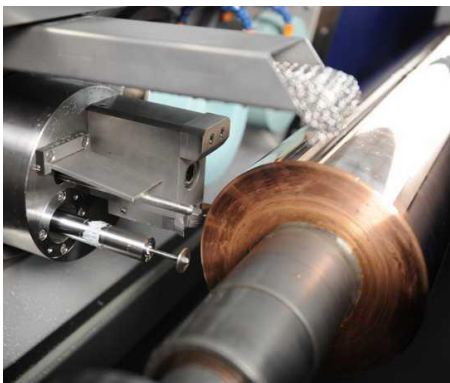
Slika 9–Automatsko mjerenje dimenzija cilindra prije obrade
