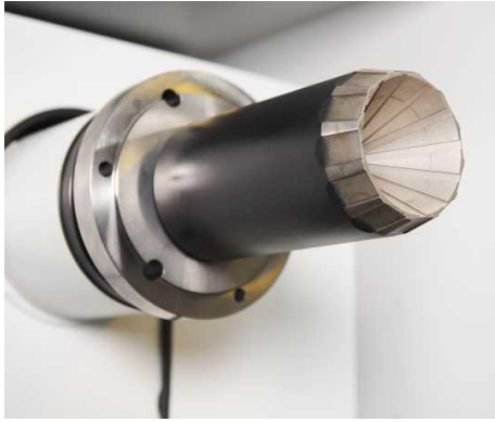
slika 21-univerzalno držači za osovinske i šuplje cilindre
