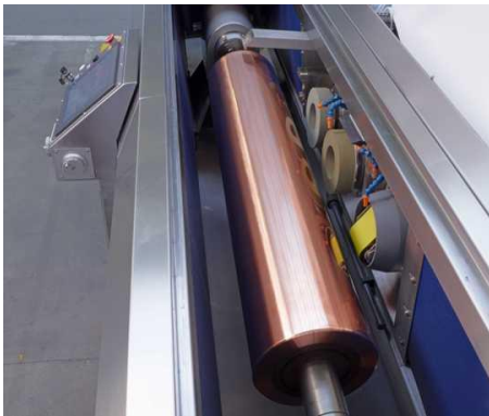
Slika 7–osovinski cilindar položen unutar kućišta stroja
