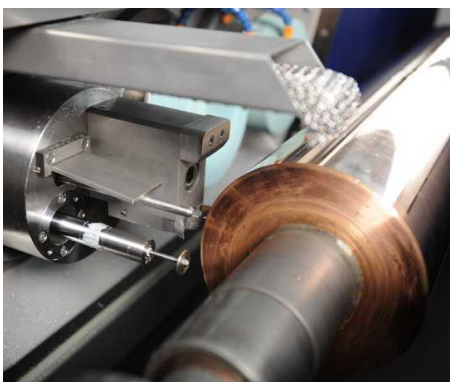
Slika 9–Automatsko mjerenje dimenzija cilindra prije obrade
