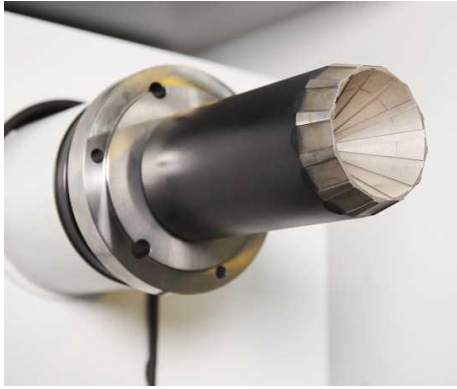
slika 21-univerzalno držači za osovinske i šuplje cilindre
