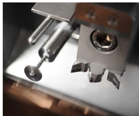
slika 10–modul za mjerenje cilindra sa držačem alata
