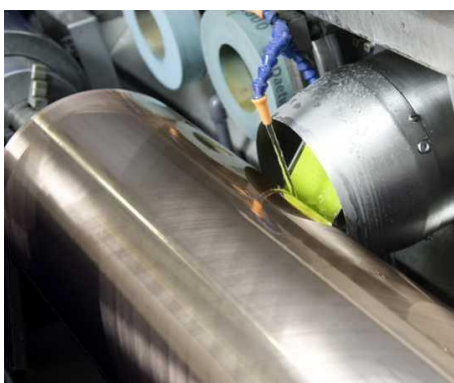
slika 15-jedinica za poliranje cilindra sa sustavom za dovod vode
