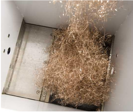
slika 17-automatski transporter viška materijala
