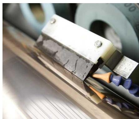
slika 16—automatski rakel za mokro i suho čišćenje cilindra
