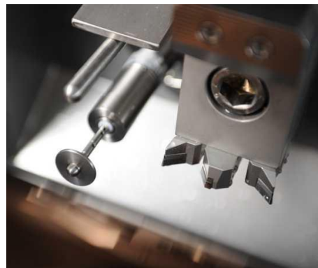
slika 10–modul za mjerenje cilindra sa držačem alata
