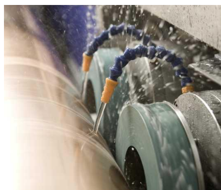
slika 14—pneumatski moduli za poliranje mogu raditi međusobno neovisno ili istodobno
