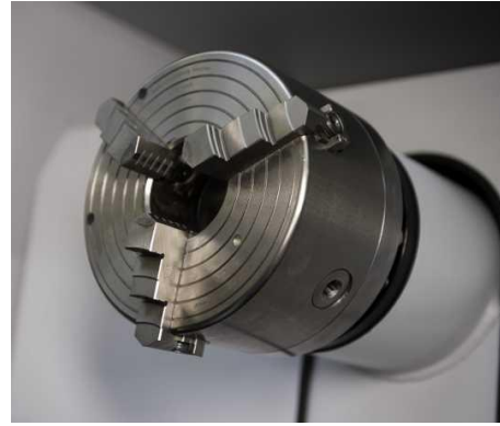
slika 22-ručna i automatska čeljust zatezne glave
