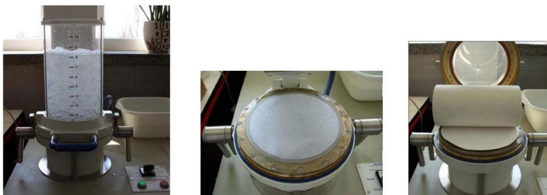
Slika 13 Proces izrade laboratorijskih listova [5*]
