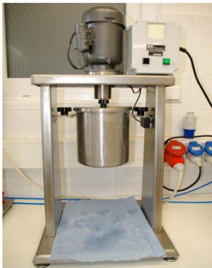
Slika 10: Izgled i shematski prikaz dezintegratora [5*]
