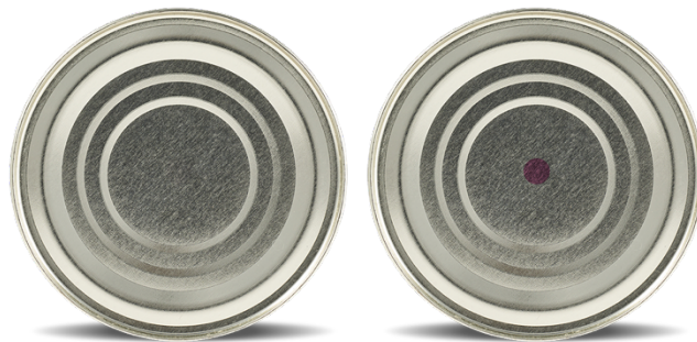
Slika 1. Nepravilno izlaganje temperaturi na metalnoj ambalaži (obezbojena boja poprimila je crvenu boju)
