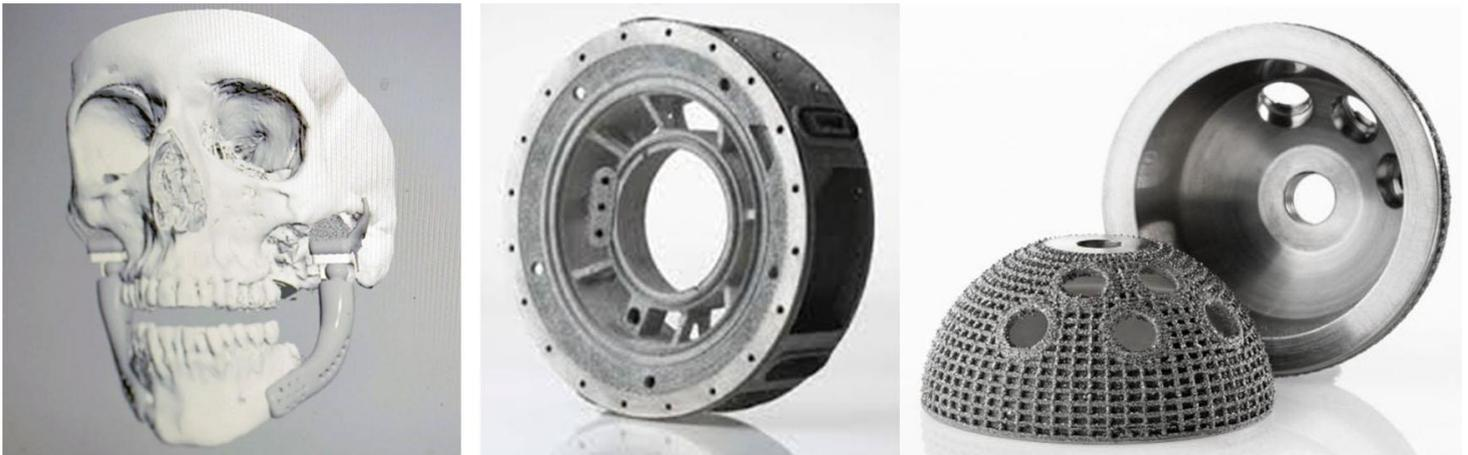
Slika 12. Primjerci 3D tiska EBM tehnologijom
