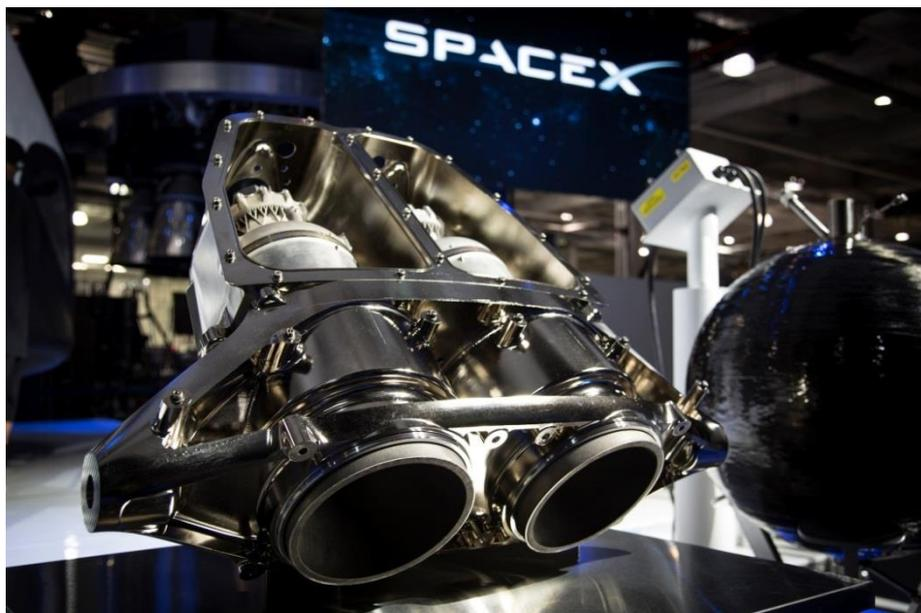
*Slika 24. SuperDraco raketni motor izrađen 3D aditivnom tehnologijom*
