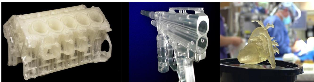
*Slika 4. Stereolitografski izrađeni prototipovi*
