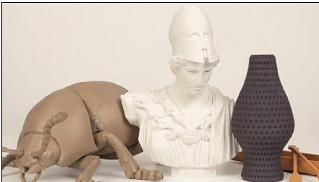
*Slika 26. Predmeti izrađeni 3D tiskom na bazi drveta, kamena i metala*
