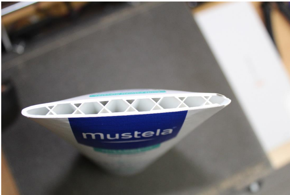
Slika 28. Prikaz unutrašnjosti tube - mrežasta struktura
