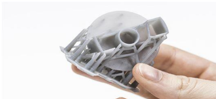
Slika 5. Prikaz otklanjanja nekog dijela ispisa (Izvor: Redwood, BenSchöffer, Filemont Garret, Brian The 3D Printing Handbook )
